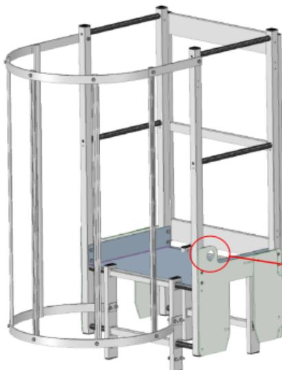
Le module d'arrivée est équipé de joues latérales fixes, et de 2 mâchoires à positionner selon l'épaisseur du blindage concerné. Ce module est livré prémonté et équipé d'un portillon à fermeture automatique.
